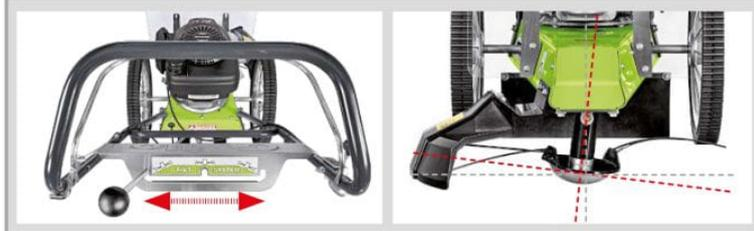
Il sistema di inclinazione rapido delle ruote a destra e sinistra, agevola il lavoro lungo le strade, vicino a muretti ed aiuole: basta una pressione con il piede sui pedali alla base del telaio.
