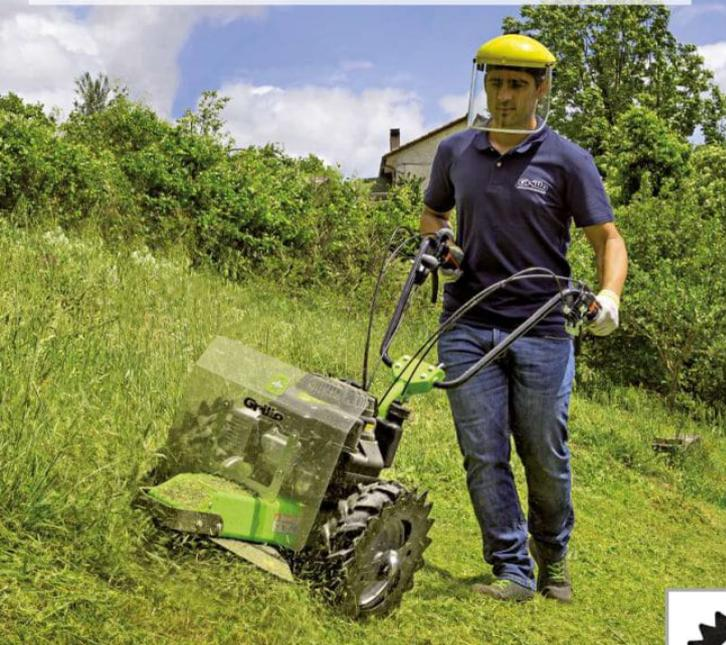
I dischi dentati in acciaio antideriva affiancati alle ruote tractor garantiscono maggiore grip su terreni scivolosi e in forte pendenza. Il montaggio dei dischi è veloce e può essere eseguito sul posto tramite un perno a coppia.
