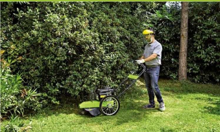
**HWT 600 WD** est équipée d'un moteur 166 cc, (4,8 HP) 4 temps à essence avec transmission à engrenages à bain d'huile et des courroies à haute résistance. Cette débroussailleuse à deux roues motrices donne la possibilité de travailler aisément dans toutes les conditions de travail. La vitesse d'avancement est de 2,5 km/h.
