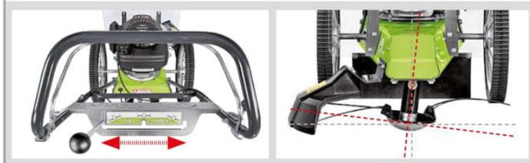
Aussi l'essieu roue est réglable en déport à droite ou à gauche pour mieux aider le travail long des rues, murs ou ronds-points. Cette opération s'effectue simplement et rapidement en soulevant légèrement l'appareil par le guidon et en appuyant sur la pédale positionnée entre les roues.
